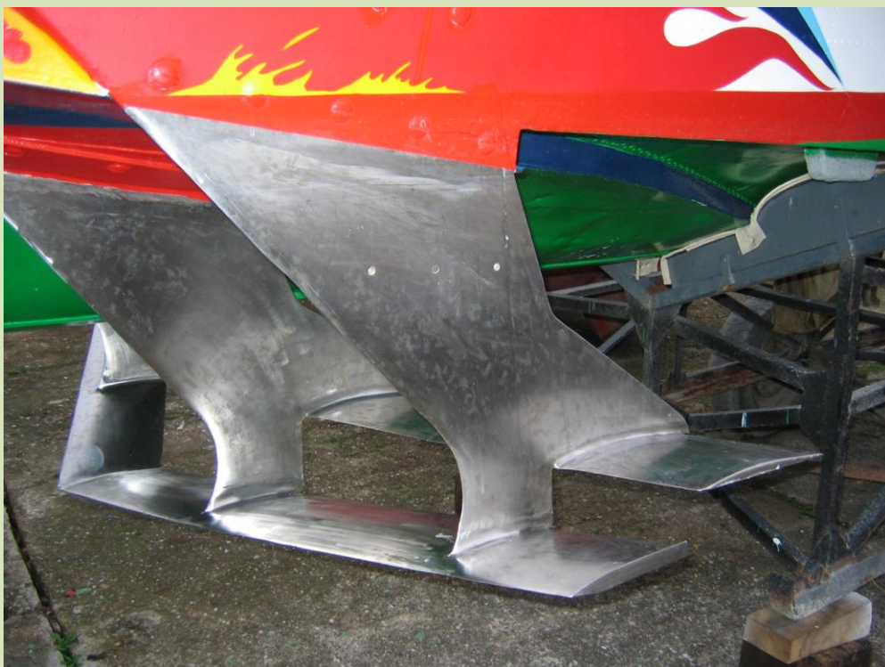
A „VOLGA” típusú szárnyas motorcsónak első hordszárnyának kialakítása. A szárnyak és a tartólábak rozsdamentes acél anyagúak.
