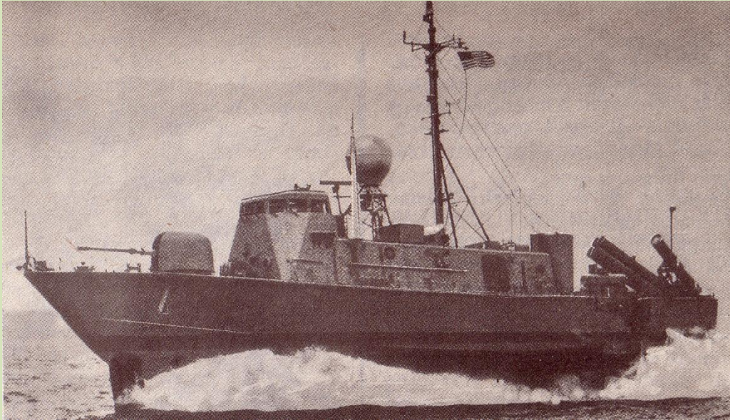
Az amerikai PEGASUS PHM 1 jelű hordszárnyas, rakétás gyorsnaszád
