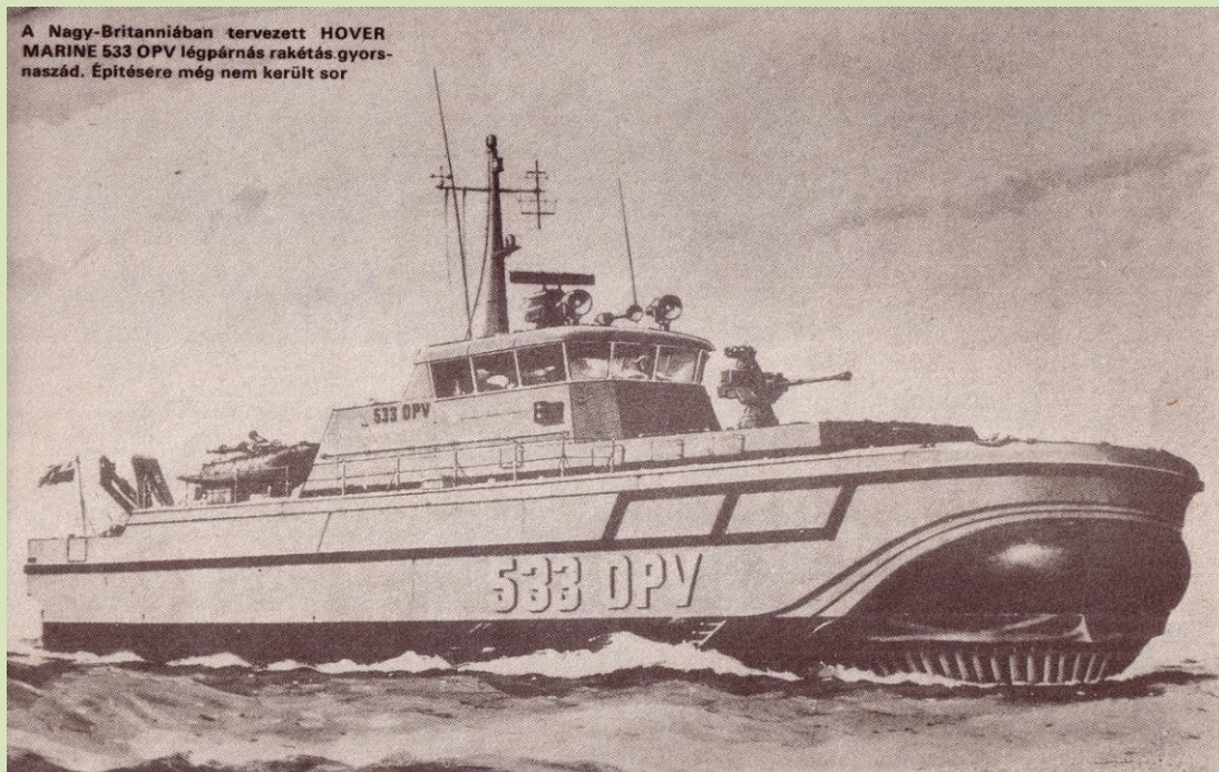
A Nagy-Britanniában tervezett HOVER MARINE 533 OPV légpárnás rakétás gyorsnaszád. Építésére még nem került sor
